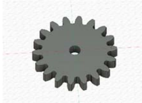
Εικόνα 3. Τρισδιάστατο σχέδιο γραναζιού έτοιμο για εξαγωγή σε μορφή .stl
